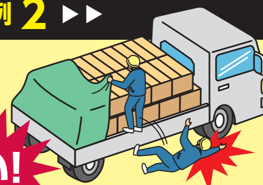
あおりに立っての シート掛け外し中の墜落事故
