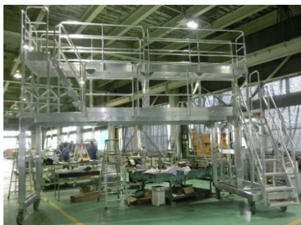
①門型タイプの作業台
