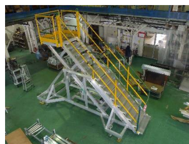
③ウインチによる昇降作業台
