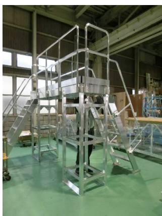
⑦Z型オーバーブリッジ
