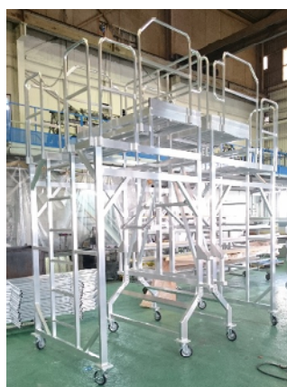
⑤高所作業台
