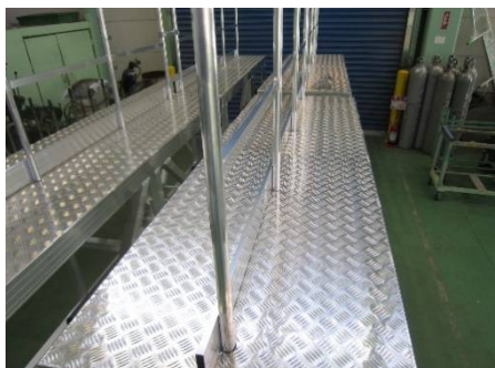
㊻手摺天板に差し込み
